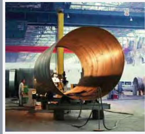
北京天海低温设备公司超大型贮罐是专为储存液化空气，如液氧、液氮、液氩、液化天然气（LNG）等深冷液体设计的立式或卧式固定珠光砂真空粉末绝热压力容器。贮罐的容积从150立方米至350立方米，最高容许工作压力为0.2~3.5MPa, 可按中国压力容器标准，德国AD2000—Merkblatt, 欧洲EN、97/23/EC PED, 澳大利亚 / 新西兰AS1210等标准要求设计制造。
